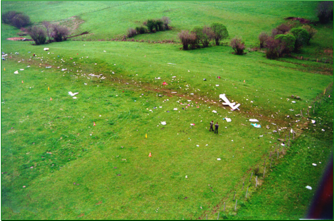
DISPERSION DE L'ÉPAVE SUR LE FLANC GAUCHE DU VALLON. AU PREMIER PLAN, LES ARBRES TOUCHÉS PAR LE ROTOR PRINCIPAL AVANT L'IMPACT AU SOL QUELQUES MÈTRES PLUS LOIN.
