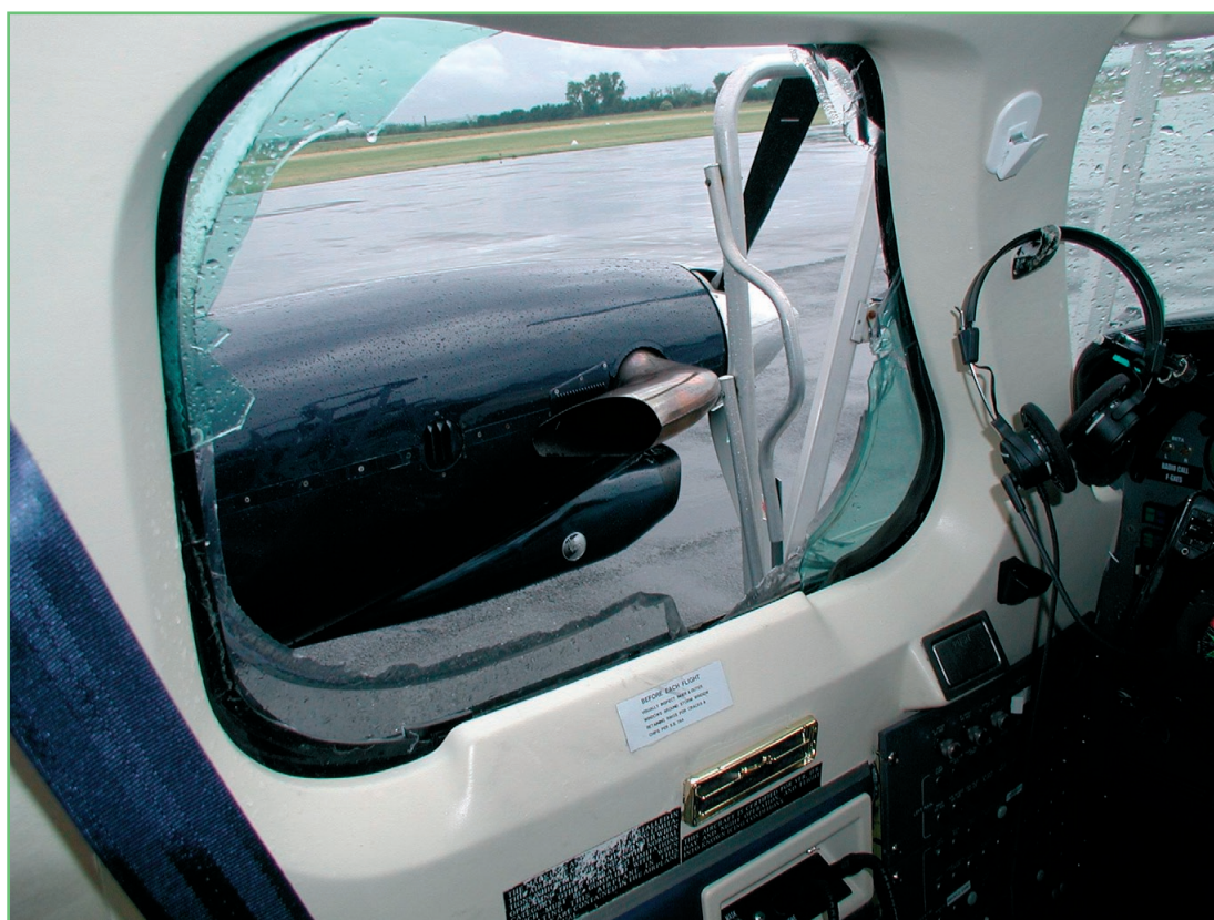
vue des dommages de la vitre latérale gauche
