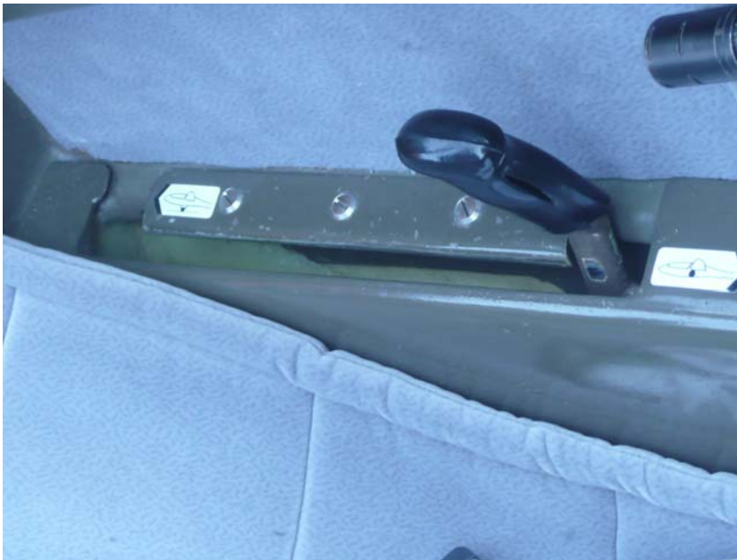
Détail de la commande du train d'atterrissage (ici sur la position « train rentré »)
