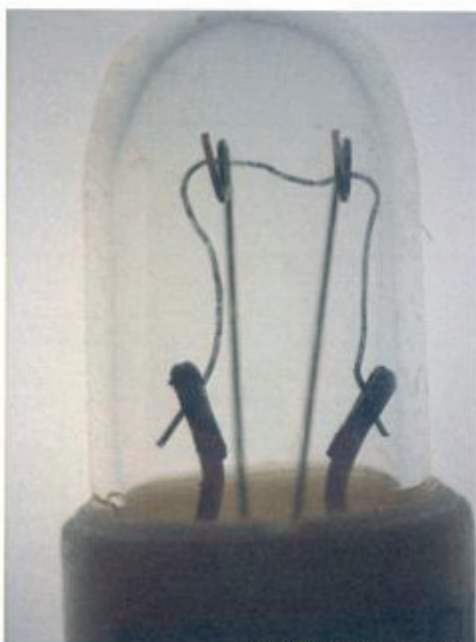
Clichés 9 et 10 : ampoules gauche et droite du voyant « BAT »
