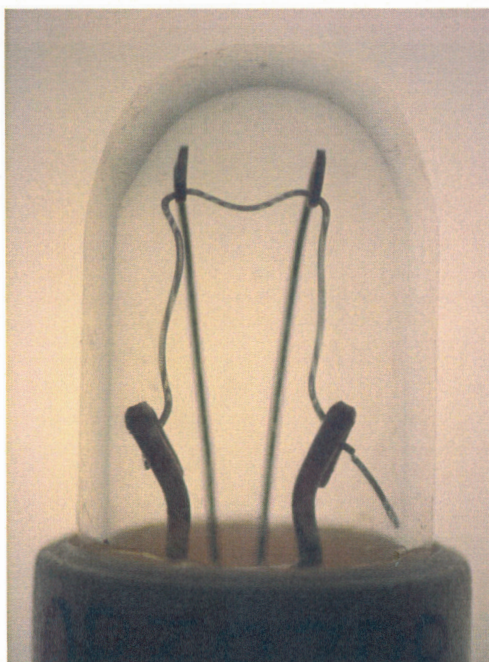
Clichés 5 et 6 : ampoules gauche et droite du voyant « MGB.T » choqué à froid
