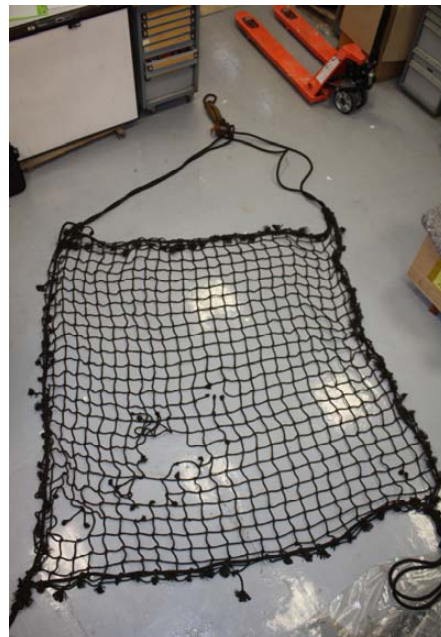
Figure 8 - Filet endommagé, relié à l'accessoire de levage par deux boucles
