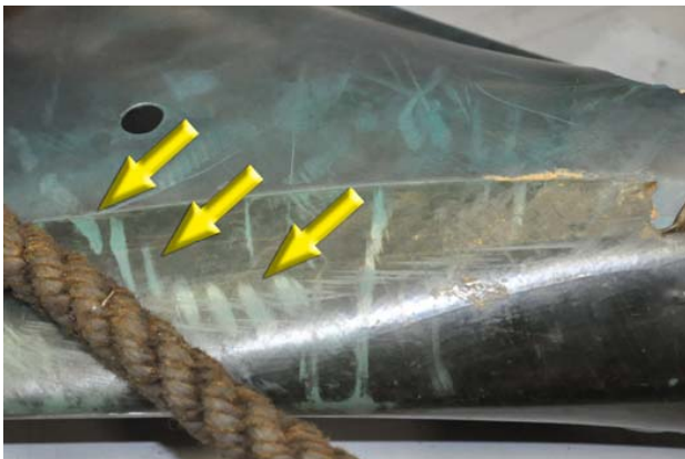
Figure 7 - Marques du filet sur la pale du RAC cassée
