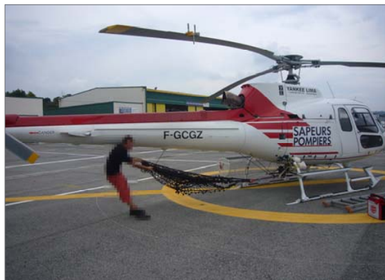
Figure 10 - Configuration avec 4 boucles en place
