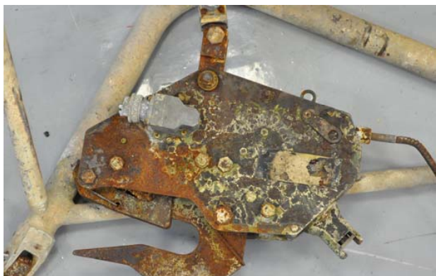
Figure 9 - Délesteur de charge brûlé
