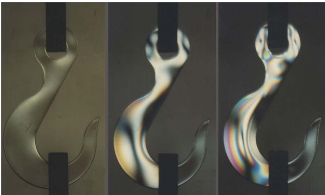
Figure 13 - Visualisation des zones de contraintes sur un crochet modèle
