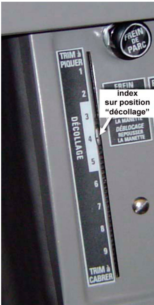
visualisation de l'index de l'indicateur de position du compensateur de profondeur depuis la place avant gauche
