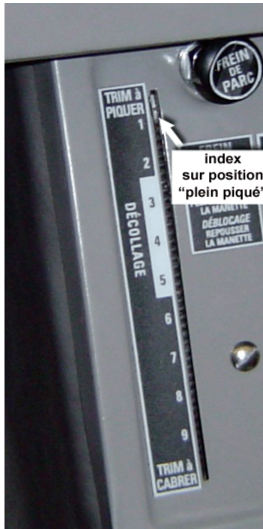
visualisation de l'index de l'indicateur de position du compensateur de profondeur depuis la place avant gauche
