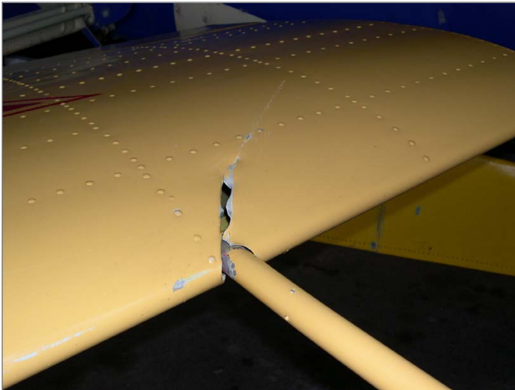
Vue des dommages de l'aile gauche
