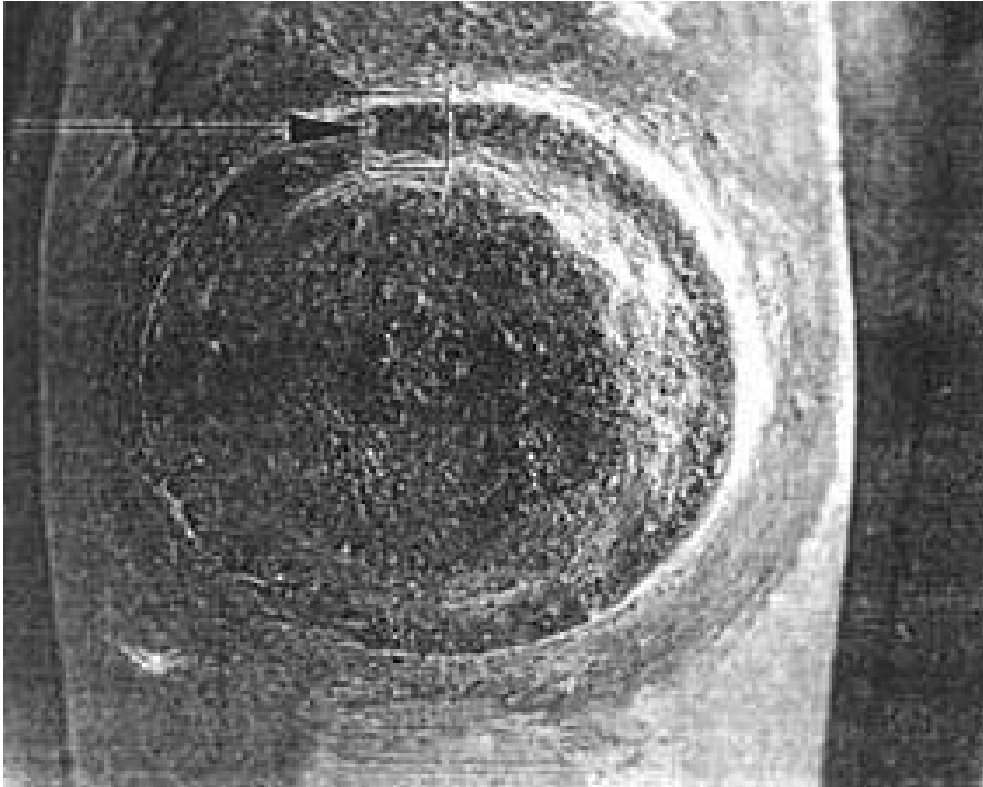
Cliché 2 : Examen micrographique d'un embout rotulé (x15)
