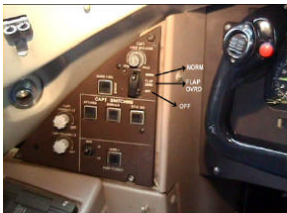
Figure 5 : Interrupteur à trois positions du GPWS en position NORMAL
