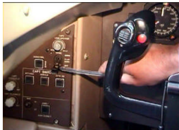
Figure 6 : Interrupteur à trois positions du GPWS en position OFF
