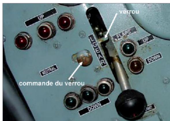
Vue de la commande de manœuvre du train d'atterrissage et du système de verrouillage
