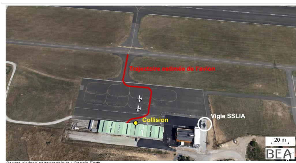
Il se focalise sur la séparation avec l'avion sur sa droite et ne vérifie pas la séparation avec les bâtiments à sa gauche. Le saumon de l'aile gauche de l'avion heurte une porte du hangar. L'avion pivote vers la gauche et l'hélice en rotation heurte le bâtiment.
