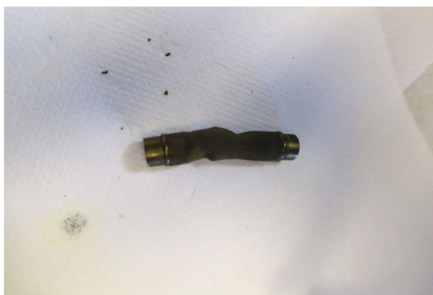
Figure 1 : filtre du carburateur déformé
