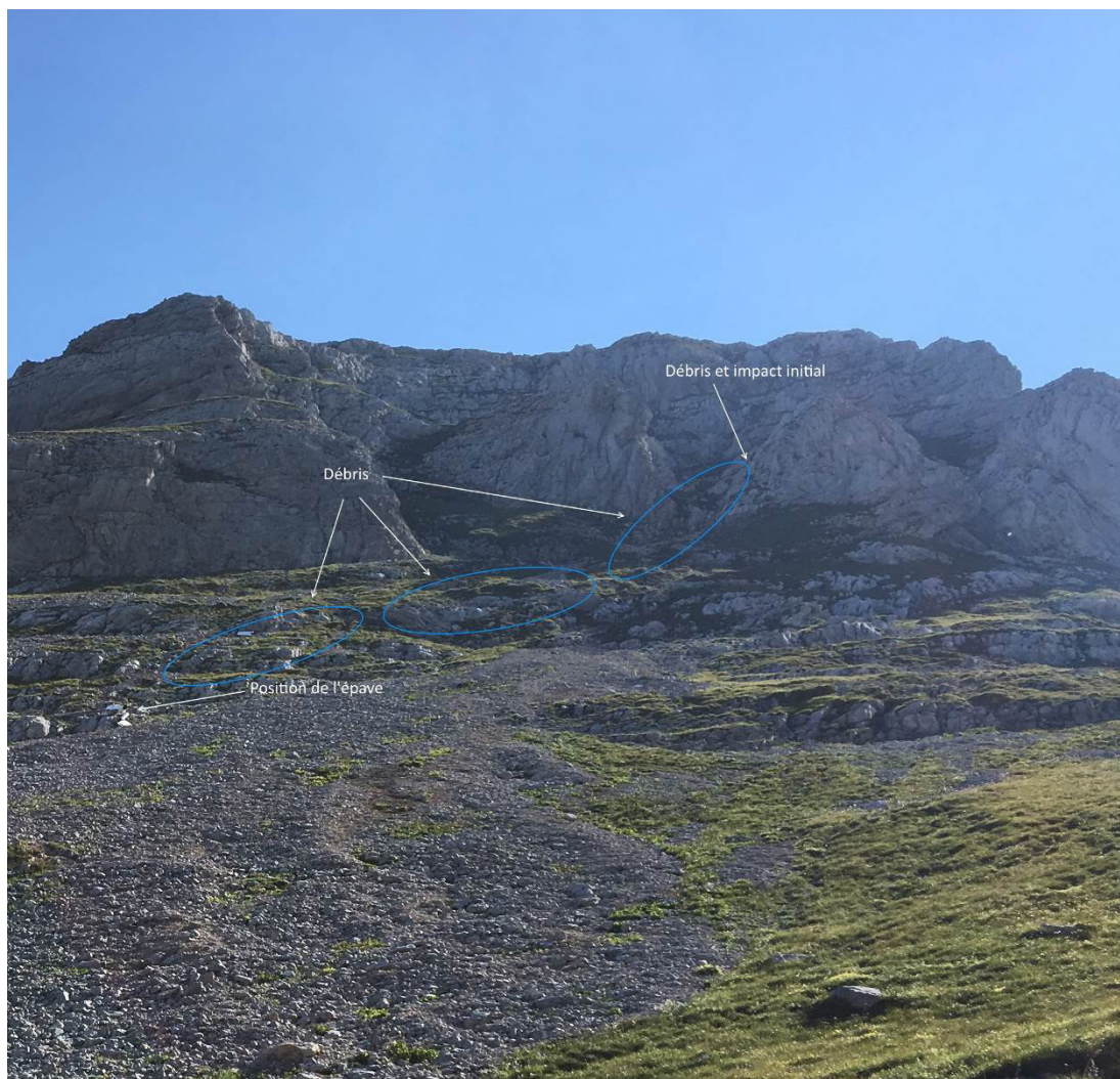
Figure 3 : répartition des débris du planeur, prise de vue face à l'est
