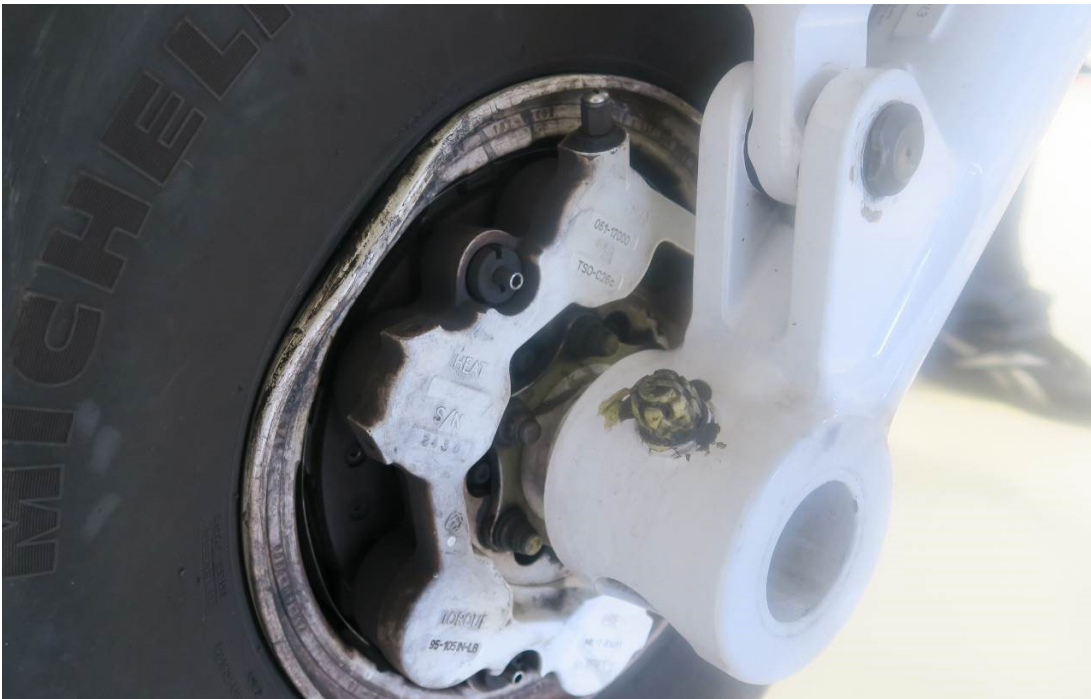
Figure 10 : Jante intérieure pneumatique du train principal gauche
