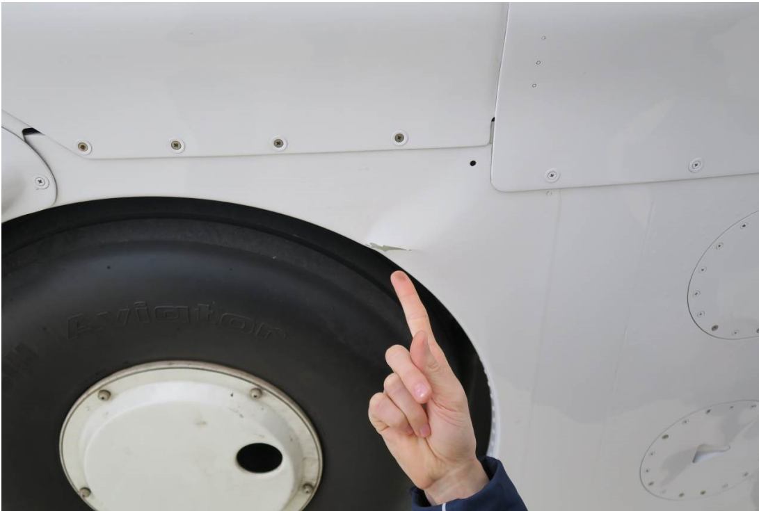
Figure 9 : Froissement de l'entourage du logement de la roue gauche
