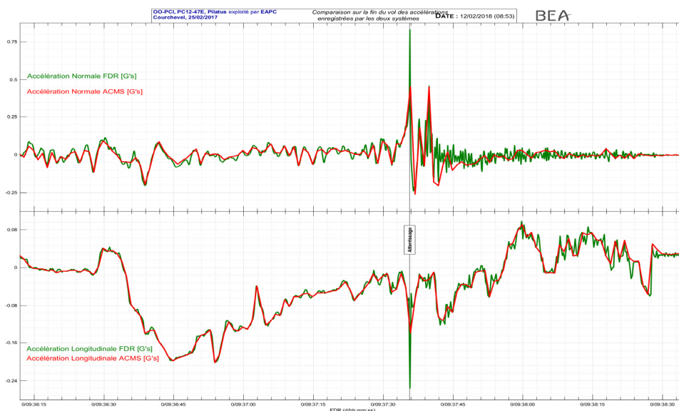
Figure 13 : Comparaison des accélérations enregistrées par les deux systèmes, ACMS et FDR
