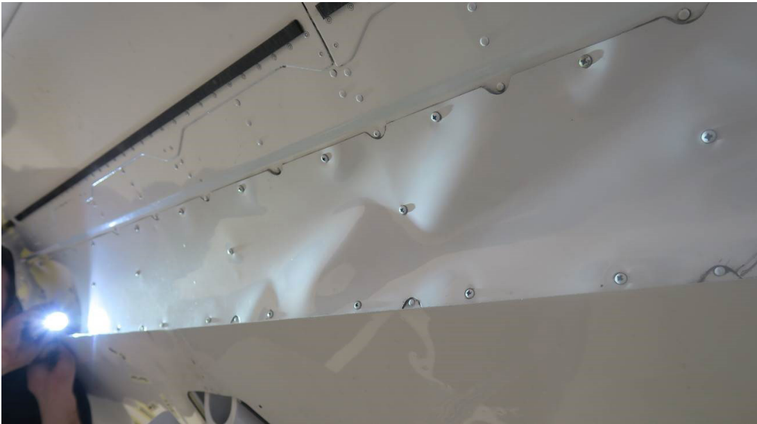
Figure 11 : Froissement de la tôle d'habillage du longeron arrière gauche
