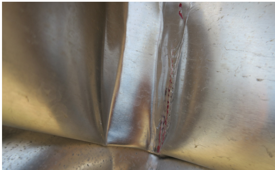
Figure 3 : Détail de l'enfoncement du bord d'attaque de l'aile droite du 57YM et traces de peinture rouge
