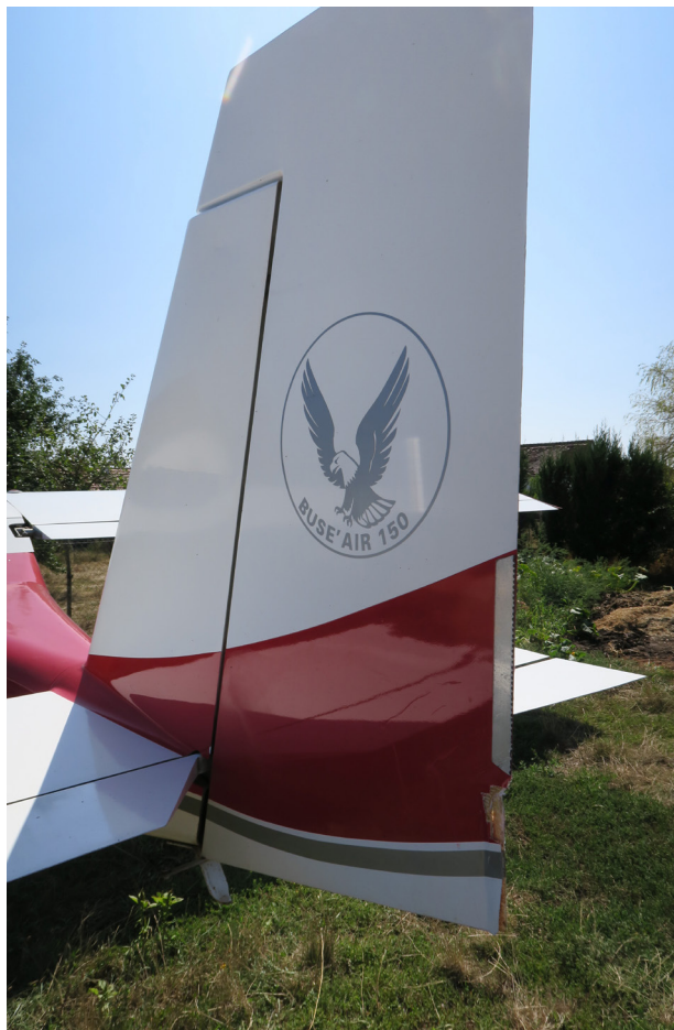
Figure 6 : Gouverne de direction et tab fixe (métal) rompu du 75WQ
