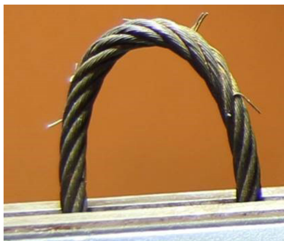
Figure 5 : Portion endommagée du câble gauche de la commande de direction
