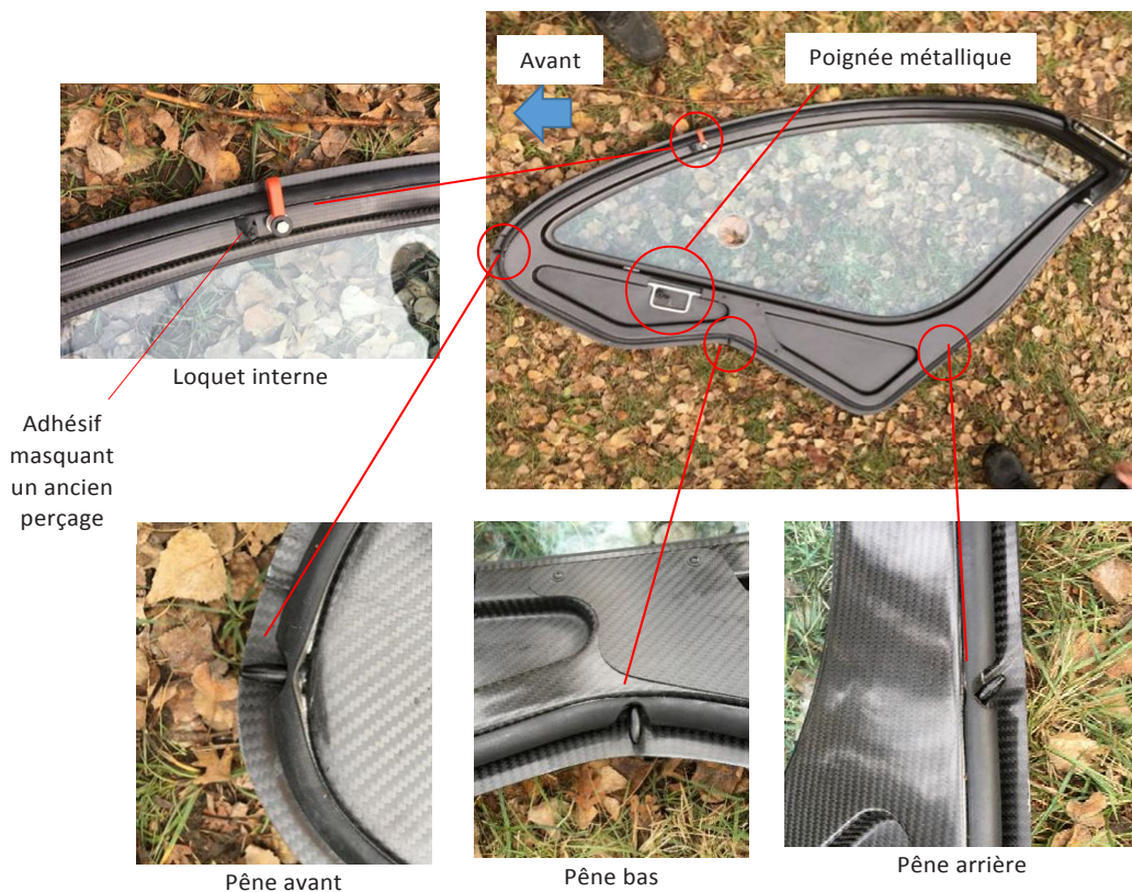
Figure 4 : Face intérieure de la porte droite (côté pilote)
