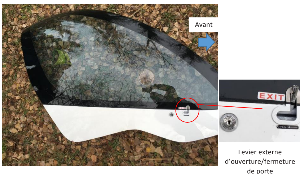
Figure 5 : Face extérieure de la porte droite (côté pilote)
