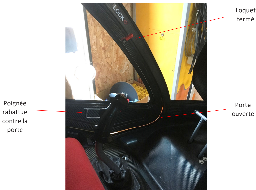
Figure 13 : Dispositif verrouillé et porte ouverte
