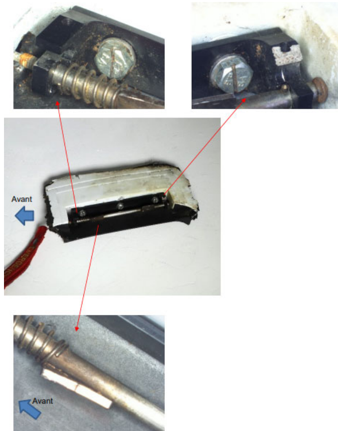
Figure 11 : Charnière côté cellule associé à la porte gauche
