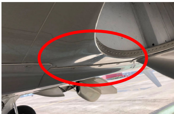
Figure 6 : Déformations observées sur l'intrados de l'aile gauche
