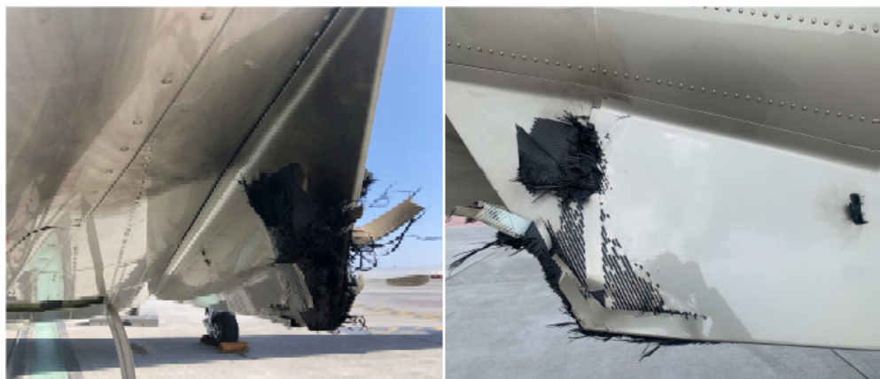
Figure 3 : Dommages observés sur la quille latérale droite
