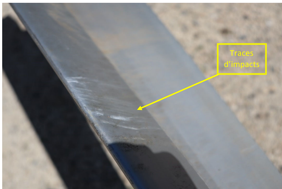
Figure 5 : Traces observées sur les pales du rotor principal
