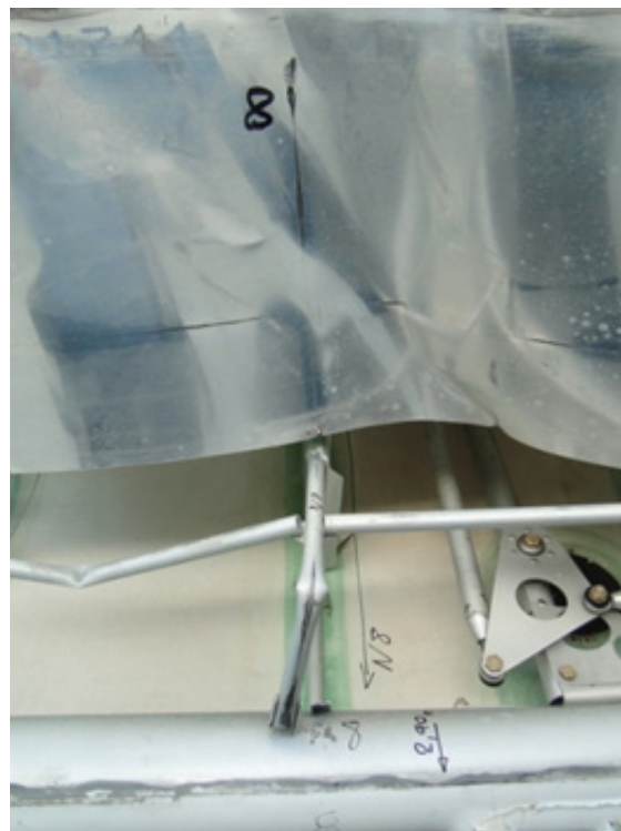
Figure 4 : détail des frottements sur la nervure 8
