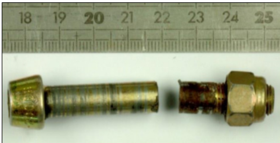
Figure 2 : vis de fixation centrale gauche rompue
