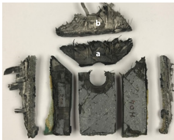
Figure 7 : découpe de l'échantillon de la figure 6 pour examen au MEB
