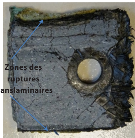
Figure 6 : endommagement par poinçonnement de la rondelle du renfort supérieur droit - vue de l'arrière
