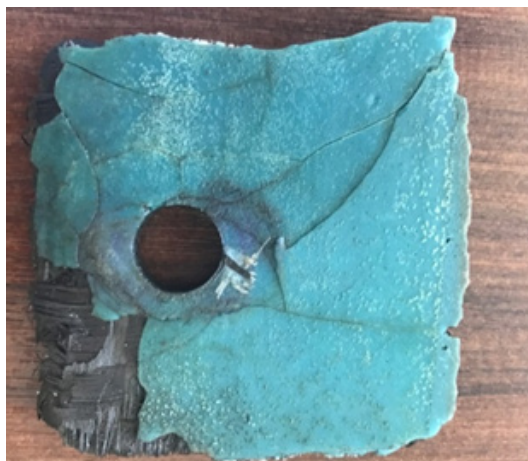
Figure 5 : rupture majoritairement adhésive du renfort supérieur droit - vue de l'avant
