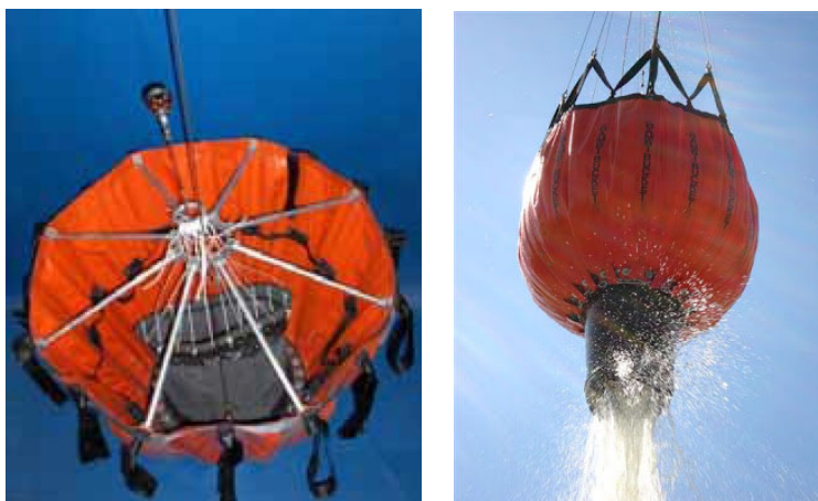
Figure 5 : Bambi Bucket prêt à l'écopage avec la vanne en position rentrée à gauche et en cours de largage avec la vanne déployée à droite
