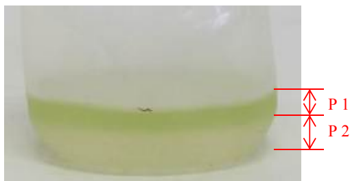
Carburant et eau récupérés dans la cuve du carburateur gauche
