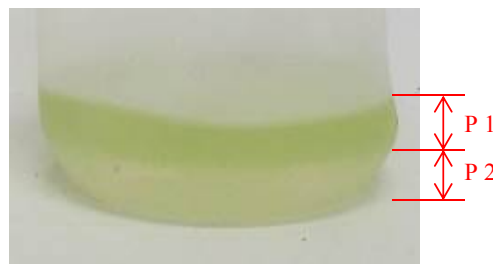
Carburant et eau récupérés dans la cuve du carburateur droit
