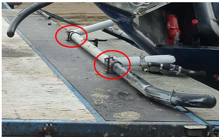
Figure 1 - remorque de transport, patin gauche et brides d'arrimage
