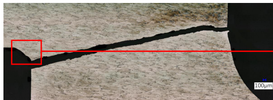
Figure 5 : vue globale de la rupture C
