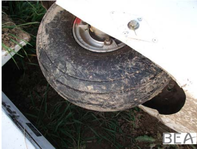
Figure 2 : présence de boue sur les pneumatiques et carénages de roues
