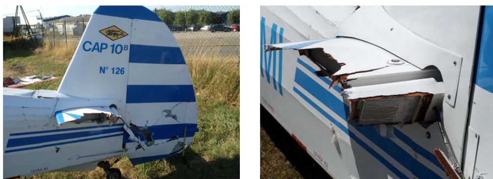
Figure 4 : endommagements du plan arrière du Cap 10 F-GUMI
