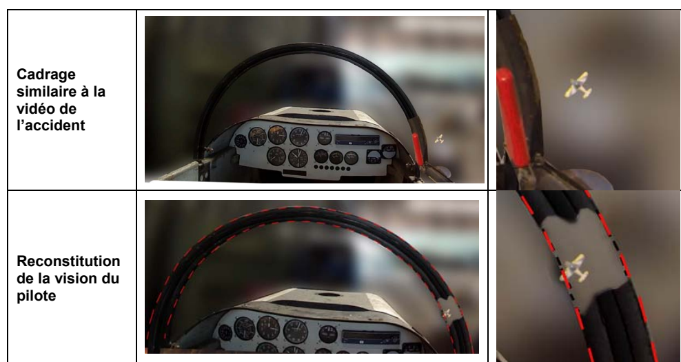
Figure 8 : exemple de reconstitution de la vision du pilote à partir de l'enregistrement vidéo
